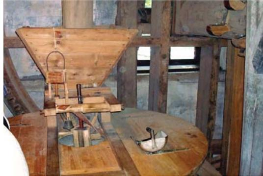
Die Mühle besitzt ein Getreidemahlwerk mit zwei funktionstüchtigen Mahlgängen und einem Sackaufzug sowie eine vollständig eingerichtete Ölmühle mit Kollergang, Leinölofen, Rührwerk und Ölpressen. Die Schrofmühle ist damit die einzige funktionstüchtige Getreide- und Ölmühle im Rheinland. Die Schrofmühle steht zwischen April und Oktober einmal monatlich für unangemeldete Besucher offen.
